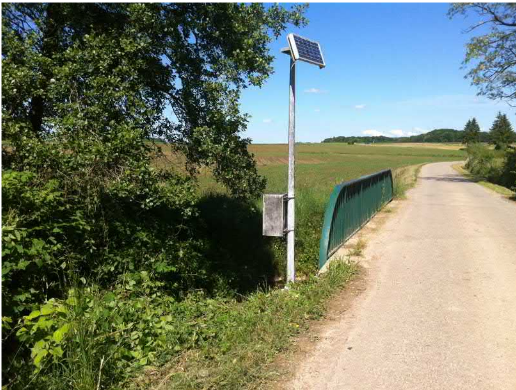
Station limnimétrique départementale sur le Traubach (Photo CD68)
